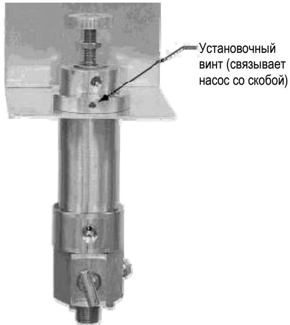
Рисунок 2.4—Узел насоса закачивания пробы и скобы в сборе
